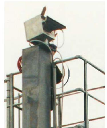
La caja protectora del explorador de líneas se monta en la parte superior de una torre.
