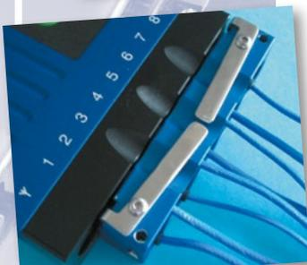
Socle de branchement des thermocouples
