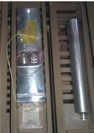
Sistema Datapaq MonoPaq2 utilizándose en una canastilla de horno tipo IBO
