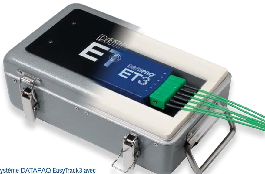
Système DATAPAQ EasyTrack3 avec bouclier thermique TB0253 standard
