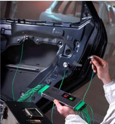
Configuration AutoPaq sur le châssis de la voiture
