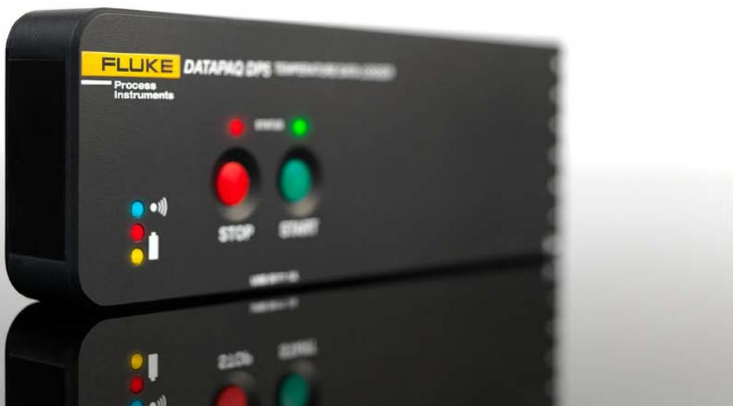
**El rango de registradores Datapaq DP5 está destinado a ser usado en procesos térmicos de corta y mediana duración; el diseño está optimizado para baja altura y capacidad de rápidas lecturas.**
