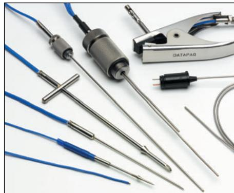
熱電対ケーブルの長さはプロセスの必要性に応じて、カスタマイズすることができます。温度センサーを製品内のデータロガー/耐熱ケースから離すようにケーブルを使用することで、データロガーの熱質量が測定中の製品の熱特性に影響することを防げます。Multipaqシステムの豊富な熱電対オプションは各プロセスの正確な状態を反映した測定を、行えるように設計されており、価値ある測定データの創造に貢献いたします。
