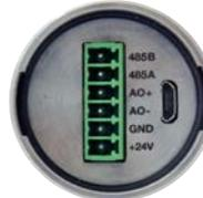
Thermalert 4.0 mit 6-poligem Anschluss für den analogen Ausgang und die RS485-Kommunikation
