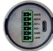
ThermalAlert 4.0 con una terminal de 6 pines que provee salida analógica y comunicaciones RS-485
